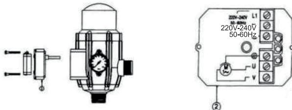
При использовании блока автоматики с трёхфазным или однофазным электронасосами, у которых максимальный ток выше 10 А, используйте электромагнитный пускатель.
